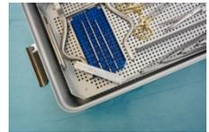
4. Coloque um indicador ou integrador de processo nos cantos opostos da cesta de instrumentos.
